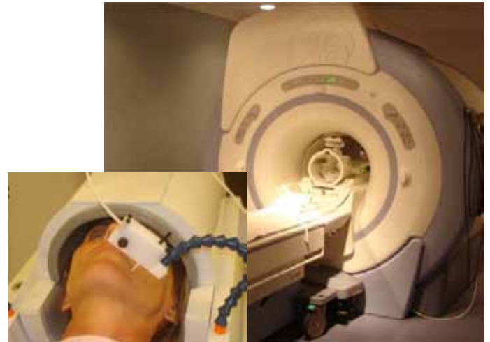
Abb.6: Experimenteller Aufbau für die fMRT-Studie Nadelstichstimulation mit einem spezialgefertigten MR-kompatiblen pneumatischen mechanischen Stimulator
